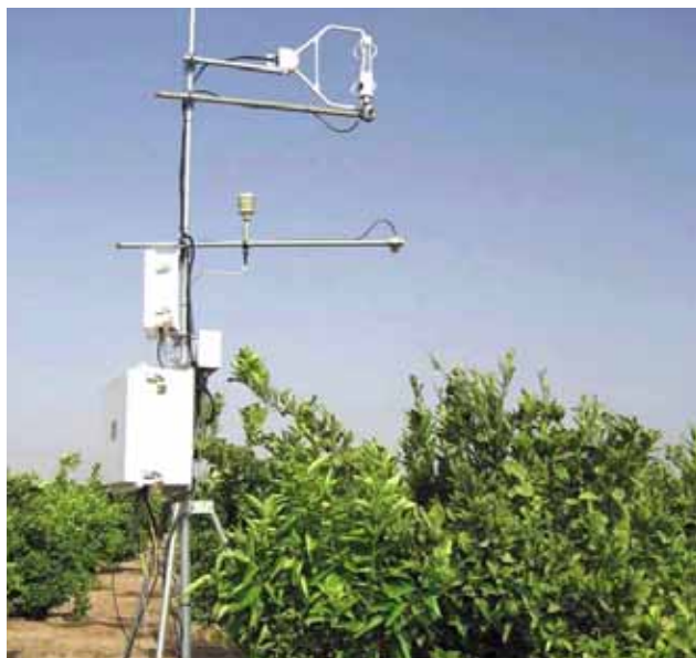
Vista 6. Sistema de medida de flujo de CO 2 por correlación de remolinos, instalado en la finca J (árboles jóvenes).
