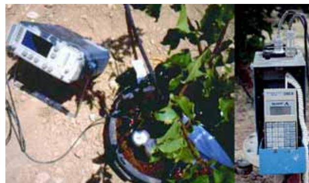
Figura 10. Equipos de medida del contenido volumétrico de agua en el suelo, TDR (izquierda) y sonda de neutrones (derecha).
