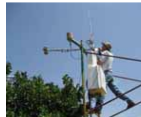
Figuras 15. Vista del equipo de “eddy-covariance” (anemómetro sónico, analizador de CO 2 y H 2 O) para la medida del flujo de CO 2 y de evapotranspiración instalado por la Universidad de Cartagena.
