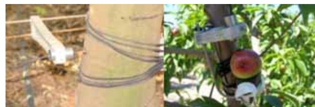
Figura 18. Sensores LVDT, en tronco de mandarina y fruto de nectarino, respectivamente.
