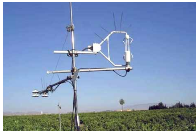
Vista 4. Equipo de eddy-covariance (anemómetro sónico, analizador de gases) para la medida del flujo de CO 2 en la finca A (naranjos adultos).
