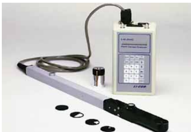
Figura 19. Vista general del sensor utilizado para la medida del índice de área foliar (LAI-2000).
