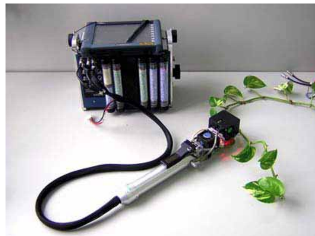
Vista 7. Medidor portátil de intercambios gaseosos CIRAS 2 ® .
