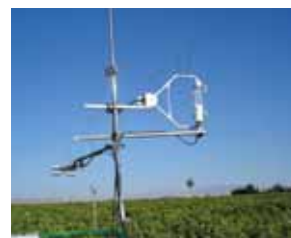
Figuras 15. Vista del equipo de “eddy-covariance” (anemómetro sónico, analizador de CO 2 y H 2 O) para la medida del flujo de CO 2 y de evapotranspiración instalado por la Universidad de Cartagena.
