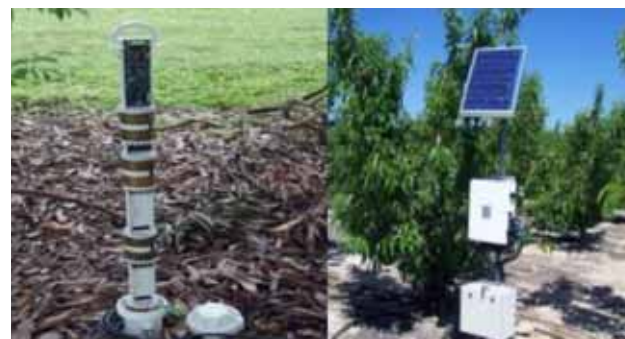
Figura 11. Equipo de medida de FDR y datalogger .
