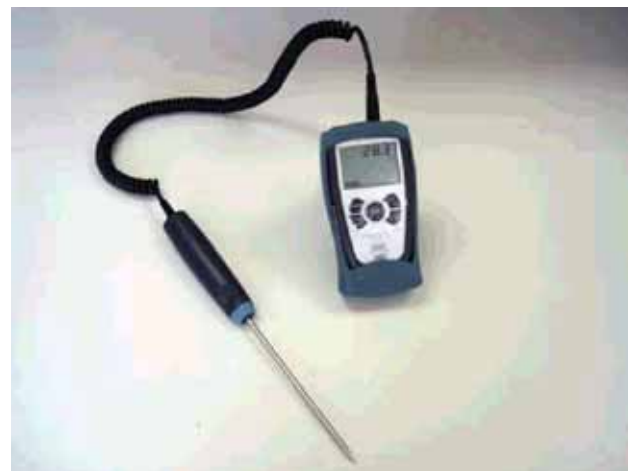
Vista 10. Medidor de temperatura de suelo.
